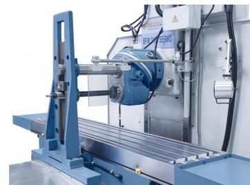
Durch die Verstellung der 90° und 45° Ebene kann der Universalschwenkkopf auf sämtliche Winkelpositionen eingestellt werden.
