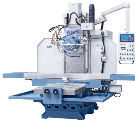
Die servo-konventionelle Bettfräsmaschine BFM 2100 Servo überzeugt durch die massive und schwere Graugusskonstruktion, wodurch diese Maschine für eine schwere Zerspanung bei großen Werkstücken optimal geeignet ist. Hauptmerkmale dieses Modells ist der Servoantrieb in allen Achsen, der großzügig dimensionierte Arbeitstisch sowie die großen Verfahrswege.
