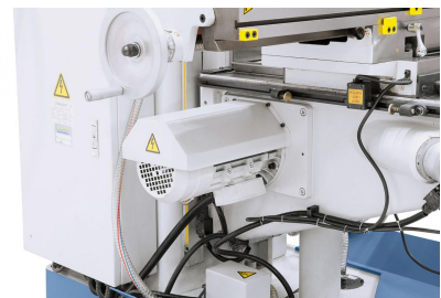
Positioniermotor für die Höhenverstellung (z-Achse) des Tisches.
