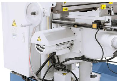
Positioniermotor für die Höhenverstellung (z-Achse) des Tisches.
