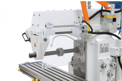
Zum Fräsen in horizontaler Position serienmäßig mit Gegenlager und langem Fräsdorn.
