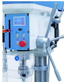
Leichtgängige Pinolenzustellung über ergonomisch angeordnete Handgriffe
