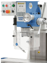
Hohe Sicherheit durch höhenverstellbaren Futterschutz mit Mikroschalter.
