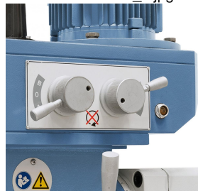
Einfache Bedienung der Schaltelemente für den Drehzahlwechsel
