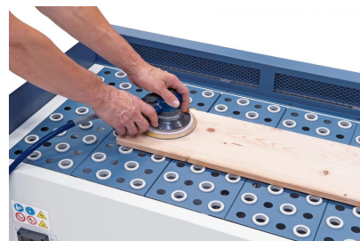
Gummierte Tischauflagen verhindern ein Zerkratzen des Werkstückes.
