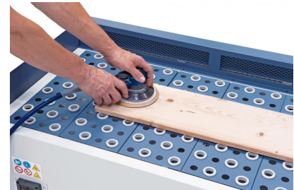
Gummierte Tischauflagen verhindern ein Zerkratzen des Werkstückes.
