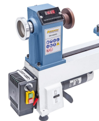
Einfaches Ablesen der Drehzahl mittels LED-Anzeige
