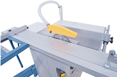
Der Sägeblattschutz mit integriertem Absaugstutzen ist am Spaltkeil befestigt.
