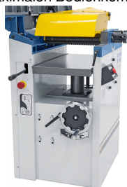
Stabiler Dickentisch mit Pinolenführung und Abstützung für exaktes Hobeln von Bretter, Leisten, Bohlen, ...
