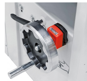
Die Einstellung der Dickentischhöhe erfolgt mittels digitaler Anzeige auf 1/10 mm genau.
