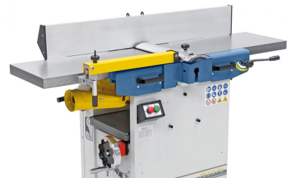
Die Einstellung der Dickentischhöhe erfolgt mittels digitaler Anzeige auf 1/10 mm genau.
