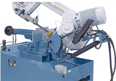
Serienmäßig mit Hydraulik-Absenkzylinder für stufenloses Absenken des Sägebügels und automatischer Endabschaltung nach Materialdurchschnitt.
