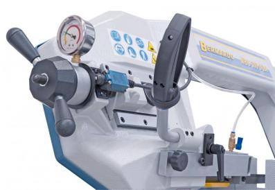
Kontrolle der Sägebandspannung mittels Manometer.
