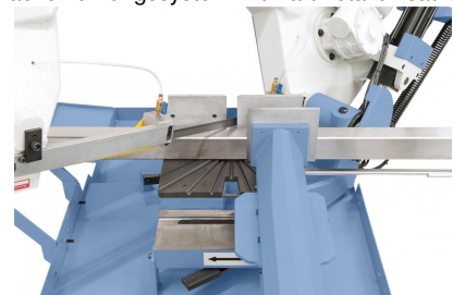
Schraubstock mit Schnellarretierung zum Doppelgehrungsschneiden verschiebbar
