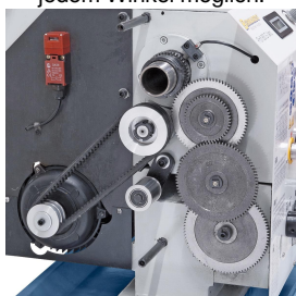
Gehärtete Hauptspindel, hohe Rundlaufgenauigkeit der Spindelnase ( \pm 0,009 mm) aufgrund Präzisionskegellager.
