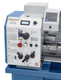
Einfache Vorwahl der Getriebestufe mittels Vorgelege, Einstellen der gewünschten Drehzahl mittels Potentiometer.
