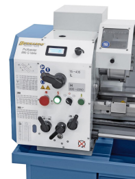
Einfache Vorwahl der Getriebestufe mittels Vorgelege, Einstellen der gewünschten Drehzahl mittels Potentiometer.
