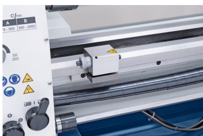
Mikrometerlängsanschlag und Rutschkupplung im Lieferumfang enthalten.
