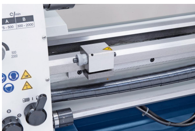
Mikrometerlängsanschlag und Rutschkupplung im Lieferumfang enthalten.
