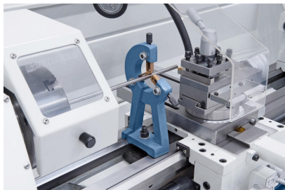
Feststehende Lünette mit Bronzeführung zum Stabilisieren von langen Werkstücken.
