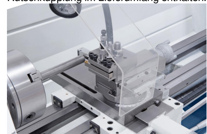
Mikrometerlängsanschlag und Rutschkupplung im Lieferumfang enthalten.
