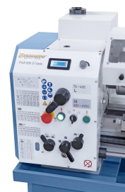
Einfache Vorwahl der Getriebestufe mittels Vorgelege, Einstellen der gewünschten Drehzahl mittels Potentiometer.
