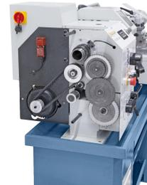
Gehärtete Hauptspindel, hohe Rundlaufgenauigkeit der Spindelnase (? 0,009 mm) aufgrund Präzisionskegellager.
