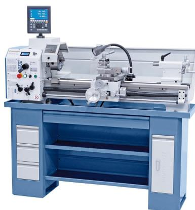
Die Vario-Drehmaschine Profi 880 G Vario ist serienmäßig mit einem Vorgelege ausgestattet, wodurch ein Wechseln der Drehzahlstufe mittels Keilriemen entfällt. Ein weiteres Merkmal dieser Maschine ist der serienmäßige Frequenzumrichter, wodurch ein hohes Drehmoment im unteren Drehzahlbereich und eine annähernd konstante Drehzahl unter Last gewährleistet wird.
