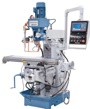
Die Universalfräsmaschine UWF 90 V wurde speziell zum wirtschaftlichen Herstellen von Einzelwerkstücken und kleinen Serien mit hoher Präzision konzipiert. Durch die große Bedienerfreundlichkeit eignet sich dieses Modell besonders für den Maschinenbau, Anlagenbau, Produktion und Einzelteilanfertigung. Weiters ist dieses Modell mit einem automatischen Pinolenvorschub ausgestattet.
