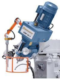
Mit dem schrägstellbaren Getriebekopf können Bohr- und Fräsarbeiten in horizontaler, vertikaler und schräger Ebene durchgeführt werden.
