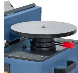
Schnelles Einstellen der Fasenbreite beim Konturfräsen durch Verdrehen des Drehtellers.
