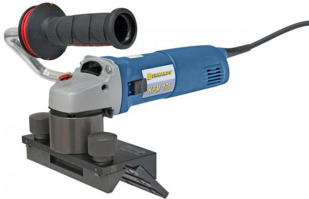
Die Kantenfräsmaschine KFM 175 wurde speziell zum Entgraten, zur Anarbeitung von optischen Fasen und zur wirtschaftlichen Schweißnahtvorbereitung von geraden Kanten konzipiert. Durch die in der Führungsschiene integrierten Laufrollen wird ein gleichmäßiger Vorschub beim Arbeiten gewährleistet.
