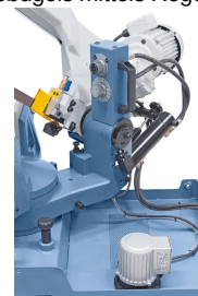
Stufenlos einstellbare Absenkung des Sägebügels mittels Regelventil.
