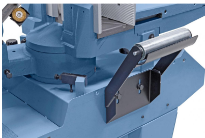
Serienmäßig mit Rollenauflage zum Abstützen von Werkstücken
