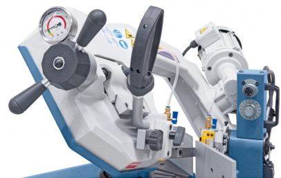
Stufenlos einstellbare Absenkung des Sägebügels mittels Regelventil.
