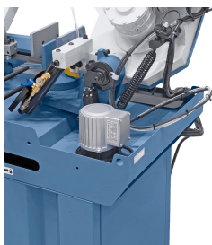
Leistungstarke Kühlmittel-pumpe im Lieferumfang enthalten
