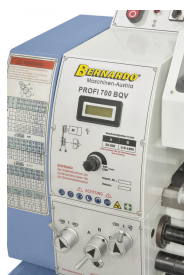
Elektronisch, stufenlose Drehzahlregelung, leichtes Ablesen mittels Digitalanzeige.
