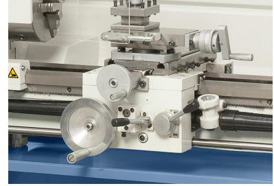
Ergonomisch angebrachte Schalthebel zur Einstellung des Längs- und Quervorschubes.
