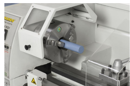
Zum Bearbeiten von großen Wellendurchmessern serienmäßig mit einer 38 mm Spindelbohrung ausgestattet.
