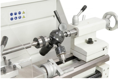
Revolverkopf zur Reduzierung der Nebenzeiten, wahlweise mit 3 / 4 oder 6 Stationen lieferbar.
