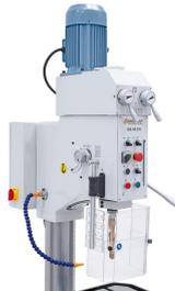
Serienmäßig mit 2-fachem automatischem Bohrvorschub ausgestattet.
