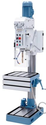
Die Getriebe-Säulenbohrmaschine ist durch ihre robuste Ausführung und großer Leistungsfähigkeit sowohl für Reparaturbetriebe als auch für die industrielle Fertigung verwendbar. Der serienmäßige Winkeltisch bietet zusätzlich vielseitige Aufspannmöglichkeiten, wodurch sich der Einsatzbereich der Maschine erweitert.
