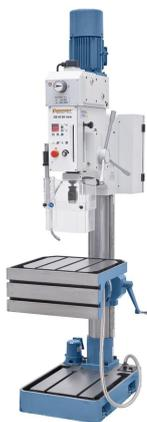
Die Getriebe-Säulenbohrmaschine ist durch ihre robuste Ausführung und großen Leistungsfähigkeit sowohl für Reparaturbetriebe als auch für die industrielle Fertigung verwendbar. Der serienmäßige Winkeltisch bietet zusätzlich vielseitige Aufspannmöglichkeiten, wodurch sich der Einsatzbereich der Maschine erweitert.
