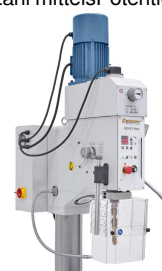
Einfache Vorwahl der Getriebe- stufe mittels Vorgelege, Einstellen der gewünschten Drehzahl mittels Potentiometer.
