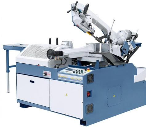
Das Modell MBS 350 VAG ist eine vollautomatische Gehrungsbandsäge (bis 60°) mit umfangreicher Ausstattung (wie z.B. NC-Steuerung, stufenlose Bandgeschwindigkeit, automatische Bandbruchkontrolle,....). Die integrierte NC-Steuerung ermöglicht ein vordefinieren der benötigten Stückzahl und Schnittlänge, wodurch eine wirtschaftliche Serienfertigung gewährleistet wird.
