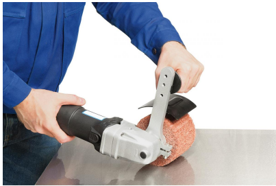
Hervorragende Oberflächengüte beim Satinieren, Polieren, Strukturieren und Mattieren (Abbildung DP 120)
