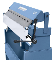
Spezielle Klemmvorrichtung für ein sicheres Klemmen.
