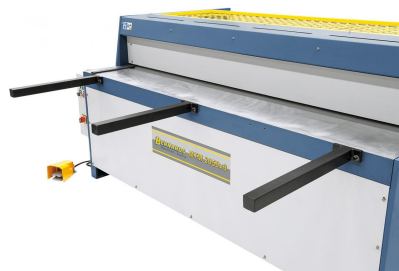
Die Auflagearme erleichtern das Bearbeiten großformatiger Bleche.
