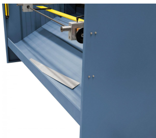
Auffangwanne für das Schnittgut an der Rückseite der Maschine.
