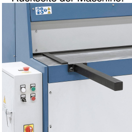
Exaktes, rechtwinkeliges Einstellen mittels seitlichem Anschlag.
