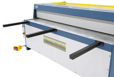
Die Auflagearme erleichtern das Bearbeiten großformatiger Bleche.
