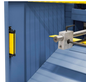
Durch die serienmäßige Lichtschränke wird ein Eingreifen in die laufende Maschine verhindert.
