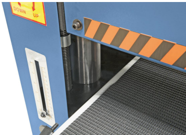
Arbeitstisch wird mittels Handrad und Skala an die Werkstückdicke angepasst.
