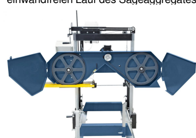
Einfacher Sägebandwechsel durch aufklappbare Abdeckungen
