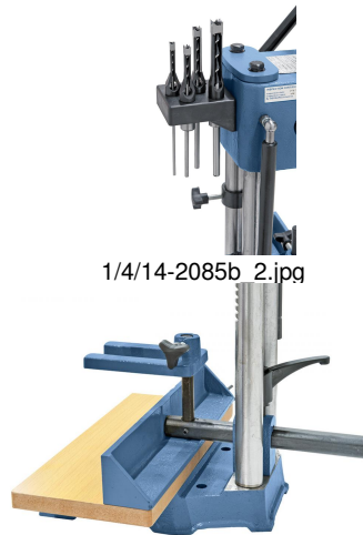
Wiederholgenaues Stemmen durch verstellbaren Werkstückanschlag
