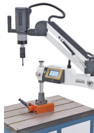
Optional erhältlicher Magnetfuß für den direkten Einsatz an großen und schweren Werkstücken.
