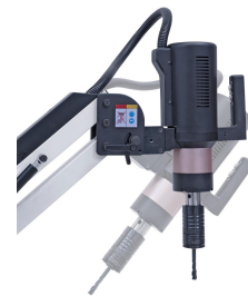
Gewindeschneiden in jedem gewünschten Winkel zwischen 0° und 90° möglich
