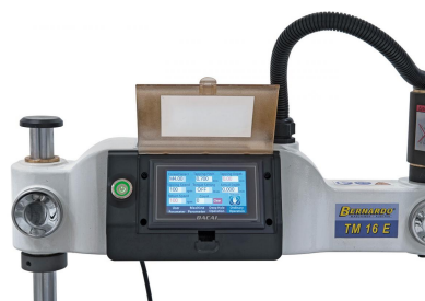
Komfortables Arbeiten: Einstellen der Gewindegröße, Steigung, Drehzahl und Bohrtiefe direkt über den integrierten Touchscreen
