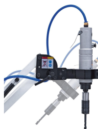
Schwenkbare Motoreinheit zum Gewindeschneiden in horizontaler, vertikaler und diagonaler Richtung.
