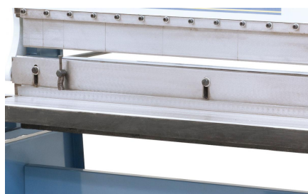
Durch die herausnehmbaren Klavier- ein-sätze ergeben sich eine hohe Anzahl von Biegemöglichkeiten.
