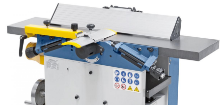
Der massive, bis 45° schrägstellbare Abrichtanschlag mit Prismenführung ist leicht verstellbar
