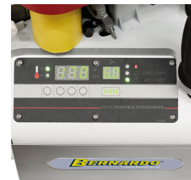
Übersichtliches Bedienpaneel, Bedienung über Folientastatur.
