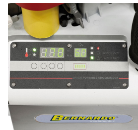
Übersichtliches Bedienpanel, Bedienung über Folientastatur.
