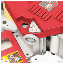
Die zugeführte Leimmenge kann über einen Drehknopf exakt eingestellt werden.
