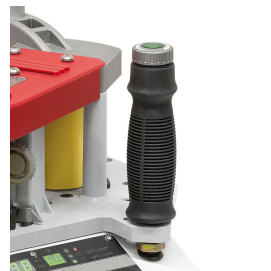
Komfortable Vorschubregelung von 2 – 6 m/min am Handgriff, ideal zum Bearbeiten unterschiedlichster Werkstücke
