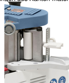
Serienmäßig mit Führungsplatte zum Anbringen des Kanten-materials in Ecken.
