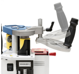
Höhenverstellbare Führungsplatte mit Skala zum Einstellen des zu bearbeitenden Werkstücks
