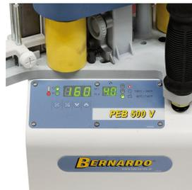
Übersichtliches Bedienpaneel, Bedienung über Folientastatur.
