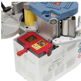
Verschießbares Leimbecken für erhöhte Sicherheit, kein Auslaufen des Klebers möglich.
