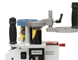
Die gewünschte Arbeitstemperatur wird mittels Potentiometer eingestellt.
