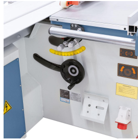
Bedienerfreundliche Höhen- und Seiteneinstellung des Vorritzers.
