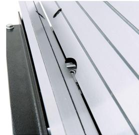
Die Fasenhöhe ist von 0 - 3 mm stufenlos einstellbar.
