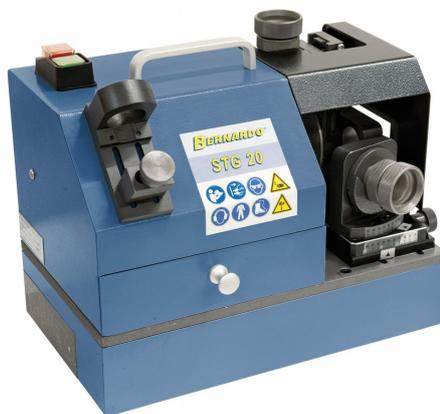
Die Gewindebohrerschleifmaschine STG 20 ist ideal zum Schleifen von Gewindebohrern aus HSS und Hartmetall. Durch den einstellbaren Spitzenwinkel von 5° bis 30° sind diese Modelle universell einsetzbar für Gewindebohrer mit 2, 3 und 4 Spannuten.
