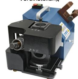
Schleifen des Freiwinkels bei 2-schneidigem Fräser
