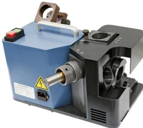
Schleifen des Freiwinkels bei 3- und 4-schneidigem Fräser
